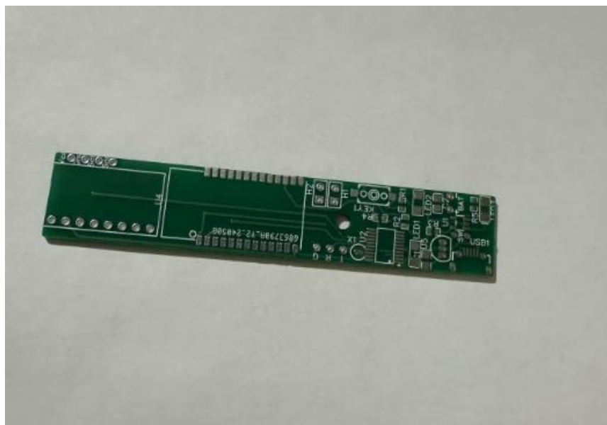
Рисунок 3.10 – Печатная плата без компонентов
